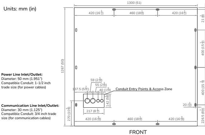
Figure 28. Conduit Box and Bolt-Down Hole Placement
